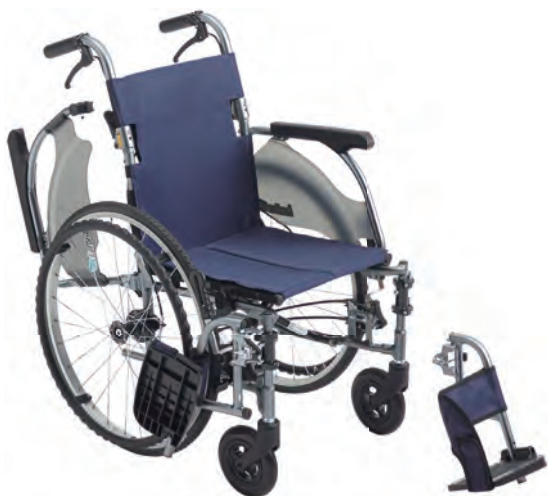
新ハイパーXフレーム 車椅子の心臓部であるXフレームを見直し、軽量化と剛性を両立。更により心地もアップしました。 ワンハンドブレーキ(特許出願済) 左右いずれかの一方のレバーを引くことで、両輪の駐車ブレーキをかけることができます。また、伸縮延長レバーを伸ばすと軽い力でブレーキを操作することができます。 軽量ハイポリマータイヤ(黒) 従来より軽量のメンテナンスフリーのノーパンクタイヤ。パンクや空気漏れの心配がないので、とても便利です。
